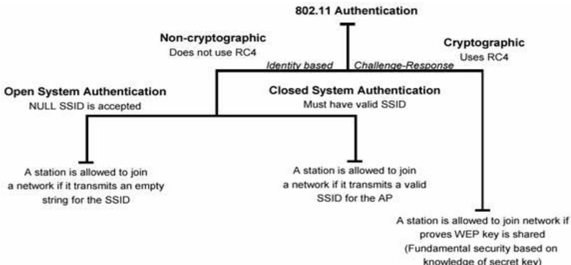
همان‌گونه که در شکل نیز نشان داده شده است، یک روش از رمزنگاری RC4 استفاده می‌کند و روش دیگر از هیچ تکنیک رمزنگاری‌بی استفاده نمی‌کند.
